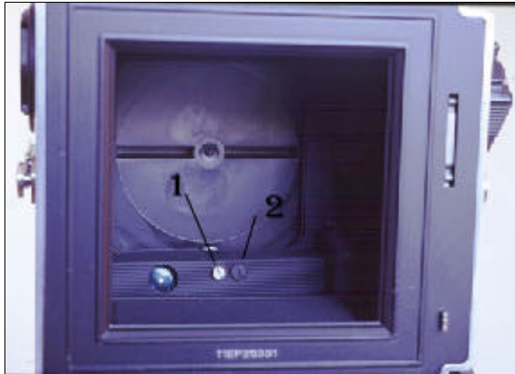
Das Bild zeigt eine 503CX mit einem "Glasauge" für den TTL-OTF-Blitz-Sensor auf der linken Seite
