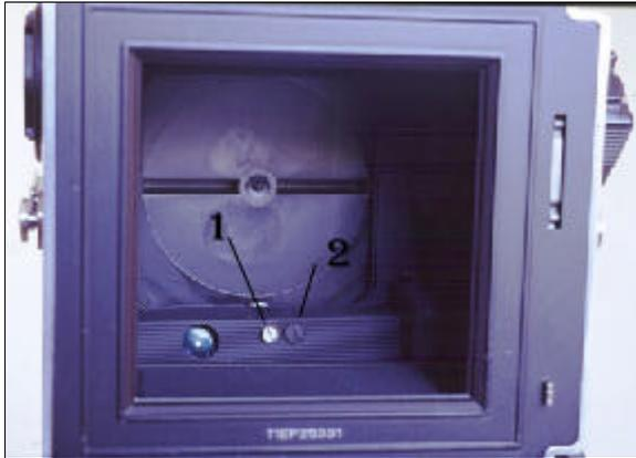
Das Bild zeigt eine 503CX mit einem "Glasauge" für den TTL-OTF-Blitz-Sensor auf der linken Seite
